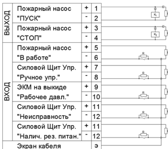
Рисунок А.6 – Подключение насосного агрегата 24 В
