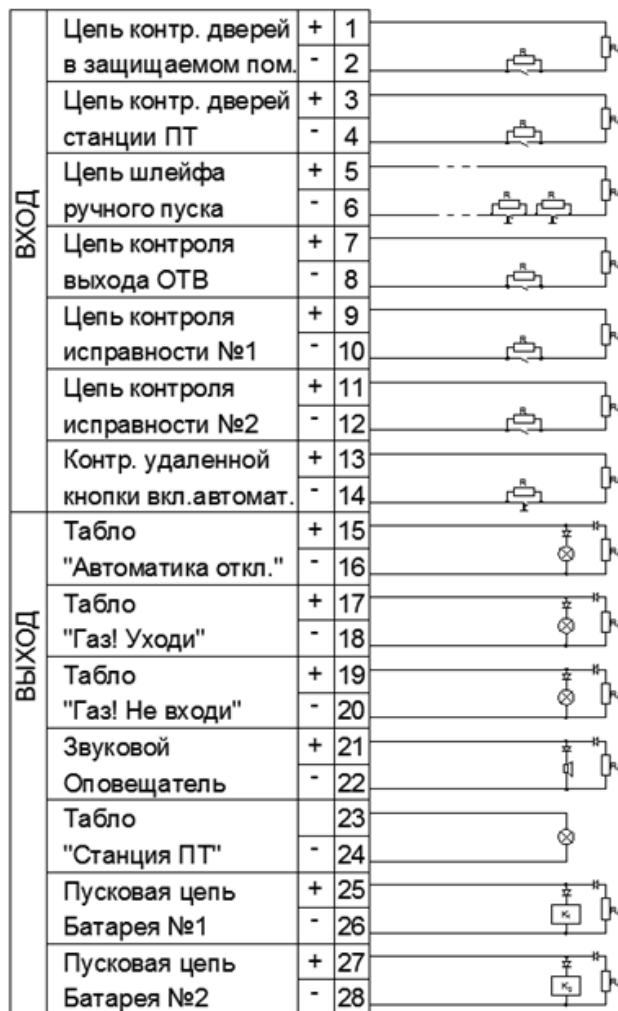
Рисунок А.7 – Подключение комбинированное (газовое тушение)
