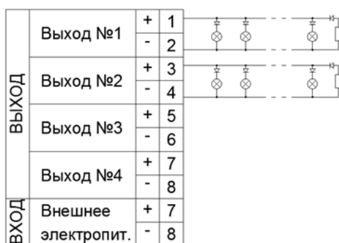
Рисунок А.2 – Подключение оповещателей
